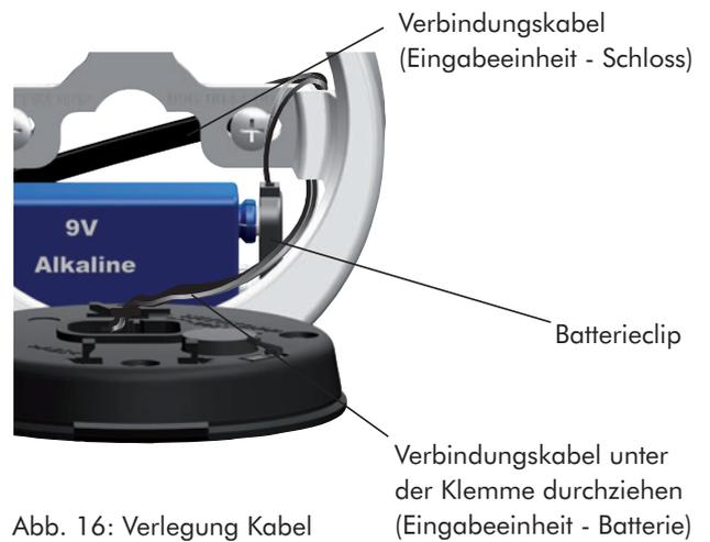
Abb. 16: Verlegung Kabel
