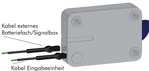
Abb. 3: Verbindung Stecker-Eingabeeinheit/Elektronikschloss
