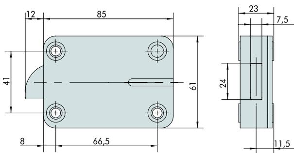
Abb. 1: Einbaumaße Schwenkriegelschloss
