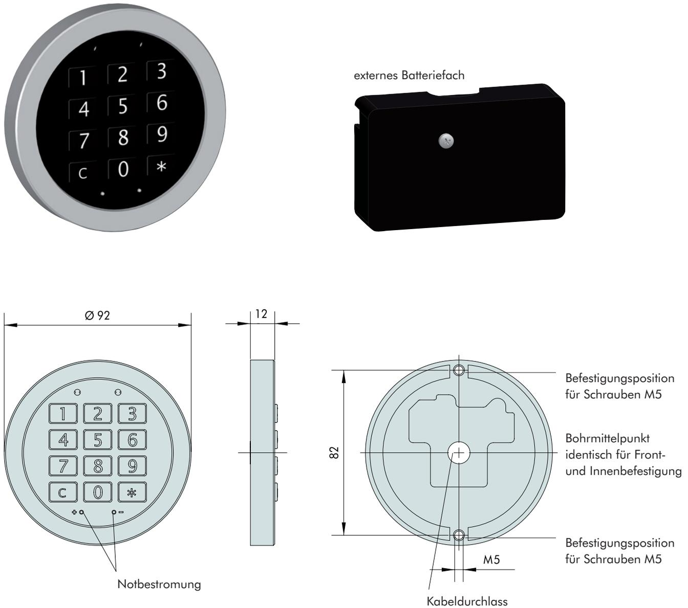
Abb. 12: Einbaumaße Innenbefestigung Eingabeeinheit FL
