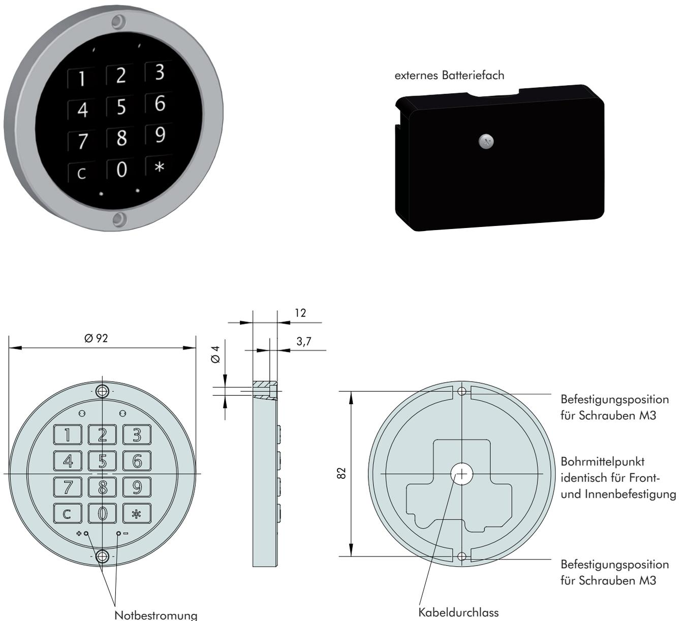
Abb. 13: Einbaumaße Frontbefestigung Eingabeeinheit FL
