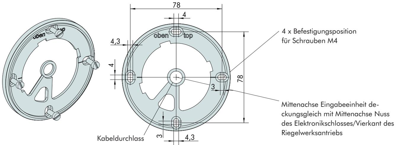
Abb. 6: Einbaumaße Befestigungsring
