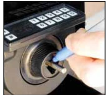
Abbildung 7: Markierung der Spindel unterhalb der Drehknopf-Oberkante
