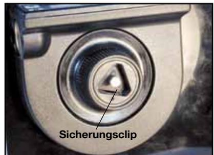
**Abb.11: Einsetzen des Sicherungsclips über der Distanzscheibe**
