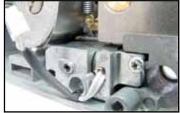
**Abbildung 8: Korrekte Kabelführung des Kabels.**
