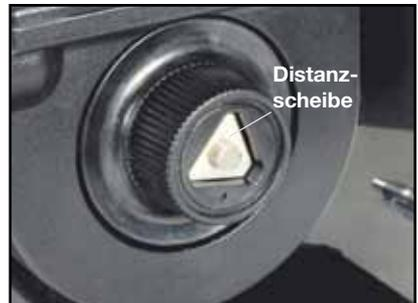
**Abb. 10: Einsetzen der Distanzscheibe**
