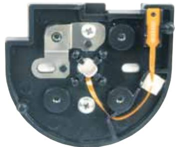
**Abbildung 5: Kabelführung innerhalb der Montageplatte (Bild: KU Gehäuse)**
