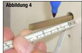
11. Markieren Sie die Spindel 31,8 mm (± 3,2 mm) vor der Außenseite der Tresortür. (Abbildung 4)
