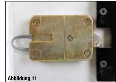
**Hinweis:** Die Schlosseinheit kann in allen Installationssituationen mit oben oder unten liegendem Riegelrad (Abbildung 11) montiert werden. Wir empfehlen, die Befestigungsschrauben für die Schlosseinheit mit dem Gewindegewissungsmittel Loctite® 262 (rot) zu sichern.
