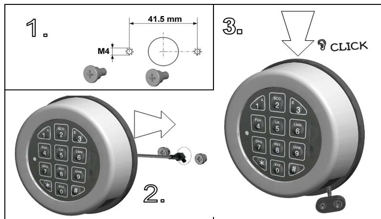
Befestigen Sie die zwei Montage-Anschluss-Schrauben (M4) handfest. Führen Sie das Kabel durch das Kabel-Loch und schieben die Einheit auf den Montageschrauben. Die Rückseite der Einheit muss die Türoberfläche berühren.
