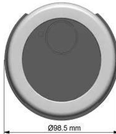
Der elektronischen Schlüssel-Anschluss befindet sich in der Forderseite neben dem Lichtsignal. Wenn er nicht benötigt wird sollte er mit dem mitgelieferten Aufkleber abgedeckt werden.
