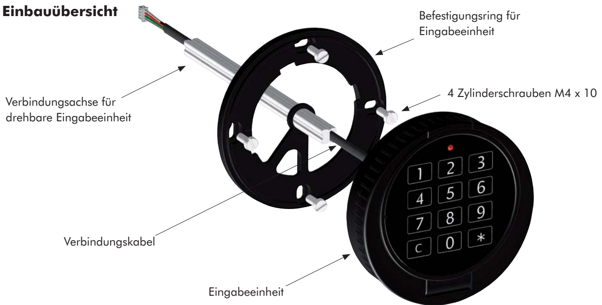
Abb. 4: Explosionszeichnung Primor RO
