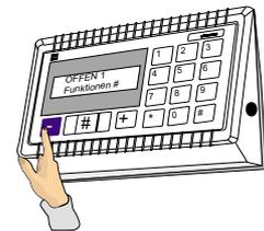
Je nach Konfiguration schließt safelock automatisch oder durch Drücken der **#**-Taste
